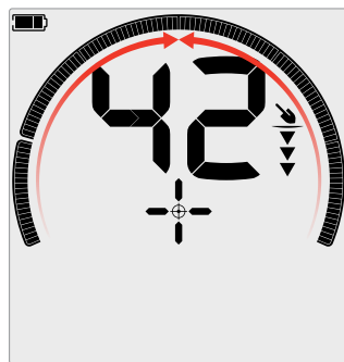
Nejsilnější cílový signál: Všechny diskriminační segmenty jsou zapnuté. Cíl je umístěn přímo pod osou cívky.
