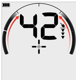
Slabý/mimo středový cílový signál: Je zapnuto méně diskriminačních segmentů. Cíl je umístěn blíže k vnější straně cívky.
